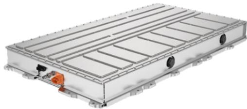
Ein effizienter Energiespeicher gilt als Schlüsseltechnologie für zukunftsfähige Elektrofahrzeuge. ElringKlinger bietet komplette Batteriespeichersysteme, Batteriemodule sowie verschiedene Komponenten, wie Zellgehäuse, Zellverbinder, Zellkontaktersysteme, Modulverbinder, Druckausgleichselemente und Batteriemanagementsysteme. Intelligent, flexibel, absolut zuverlässig und praxiserprobt.
