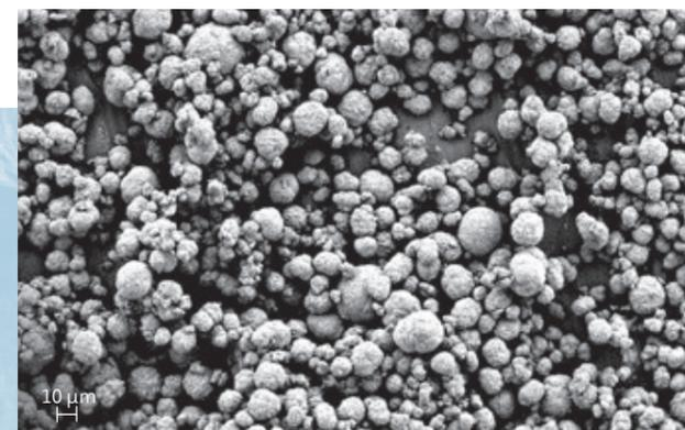
// Das ZSW entwickelt seit Jahren kobaltfreie Kathodenmaterialien (REM-Aufnahme) auf der Basis von kobaltfreiem Lithium-Nickel-Manganoxid (NCM).
